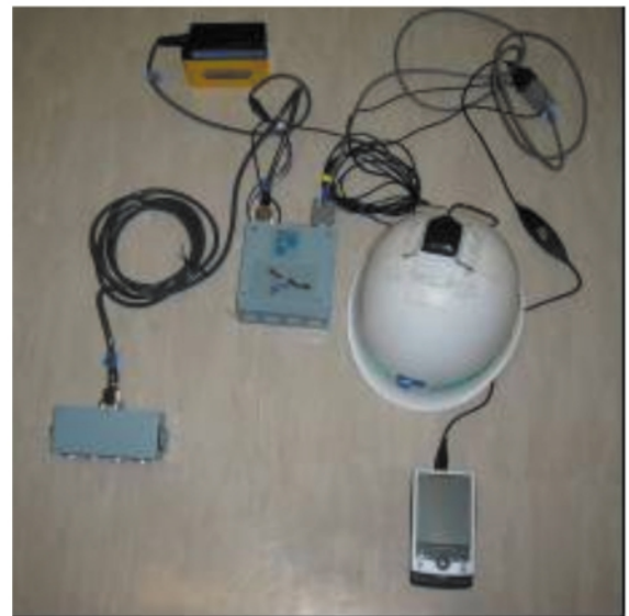
上の写真は、現地調査において使用した機器類。GPS本体、バッテリーについてはリュックに収めて調査を実施した。
